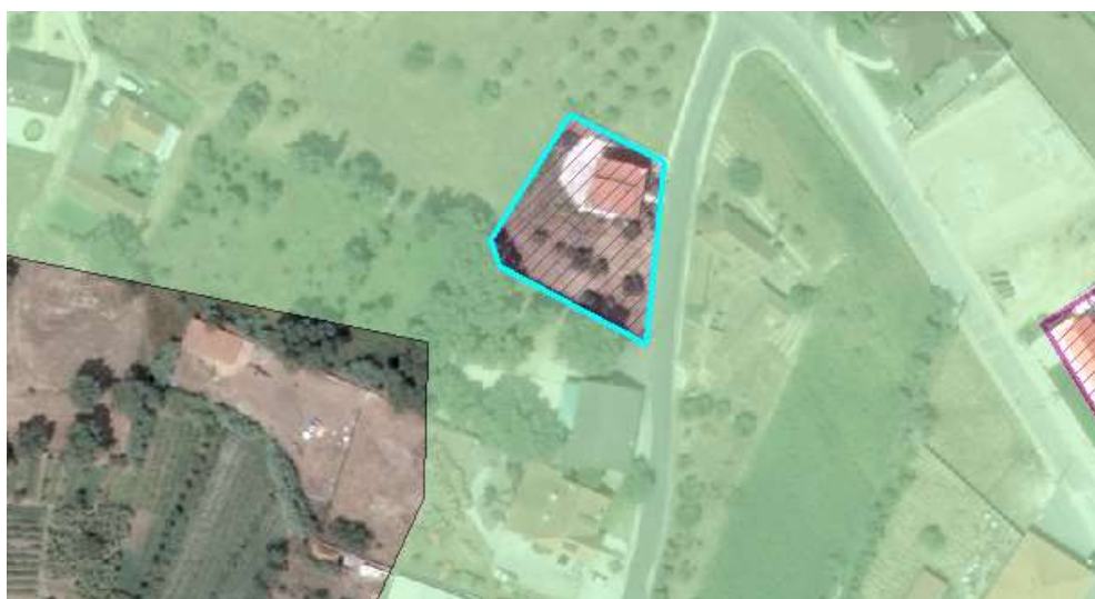
Figura 5.6 - Localização incorreta da zona sensível (polígono azul). Delimitar no equipamento no edifício a sul.
