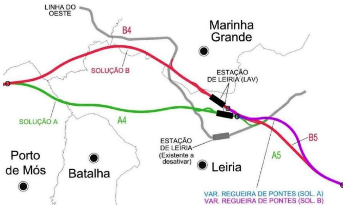
Figura 11– Esquema dos traçados do trecho 3 (Fonte: EIA, Subtomo 10.1.02–Relatório Síntese)
