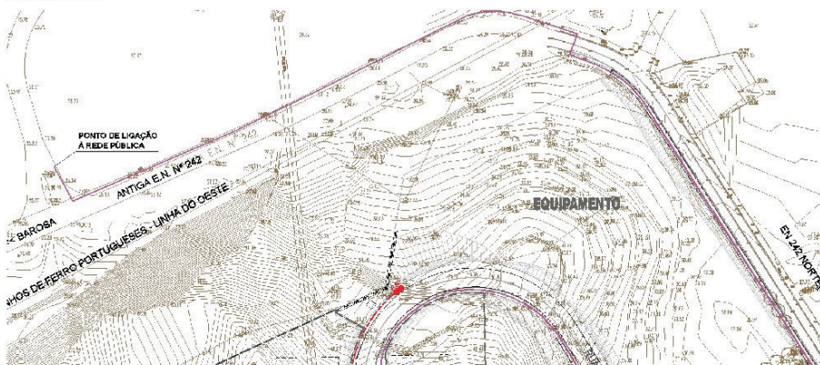
FIG. 5 – Excerto da Planta da rede elétrica de média e baixa tensão. Traçado proposto para a linha de média tensão (linha rosa), ao longo da EN242 (decl.) paralelo ao emissário.
