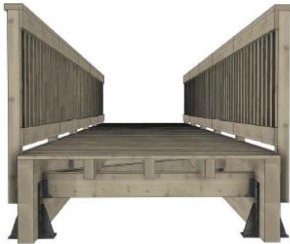
Figura 08. Proposta da execução do reforço e passadiço
