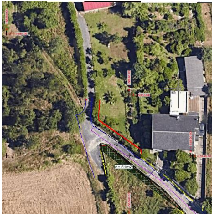
Figura10. Muros para alargamento
