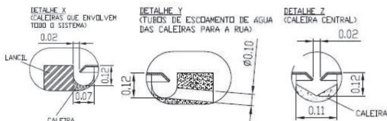
Figura 2: Detalhes das caleiras para escoamento eficiente de águas pluviais
