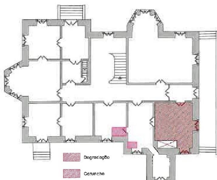
Figura 28 - Localização das patologias na face superior do pavimento da rés-do-chão
