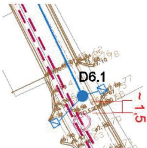
FIG. 2.1 – [EM CIMA] Excerto da Planta da Proposta do Projeto no troço com sobreposição deste com o sistema adutor: a traço descontínuo na cor castanha é representada a conduta adutora em FFD DN700 e o caboduto; Na cor azul representa-se a rede de águas residuais domésticas projetada; na cor verde representa-se a rede de águas pluviais; a traço descontínuo na cor laranja a futura rede de saneamento (fora do âmbito do projeto)
