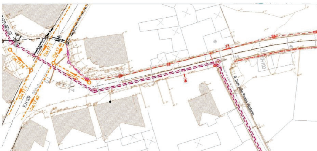
FIG. 2 – Excerto da Planta do Existente no troço com sobreposição do projeto com o sistema adutor: a traço descontinuo na cor castanha é representada a conduta adutora em FFD DN700 e o caboduto; A vermelho órgão e rede de águas pluviais; a traço descontinuo na cor laranja a futura rede de saneamento (fora do âmbito do projeto)
