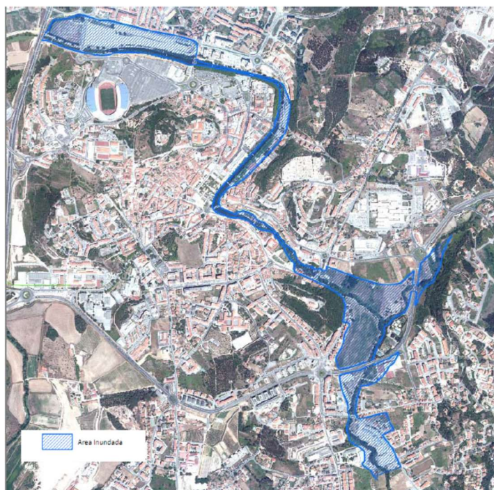
Figura 1 – Limites das áreas inundáveis conforme previsto no Estudo hidrológico/hidráulico do Rio Lis
