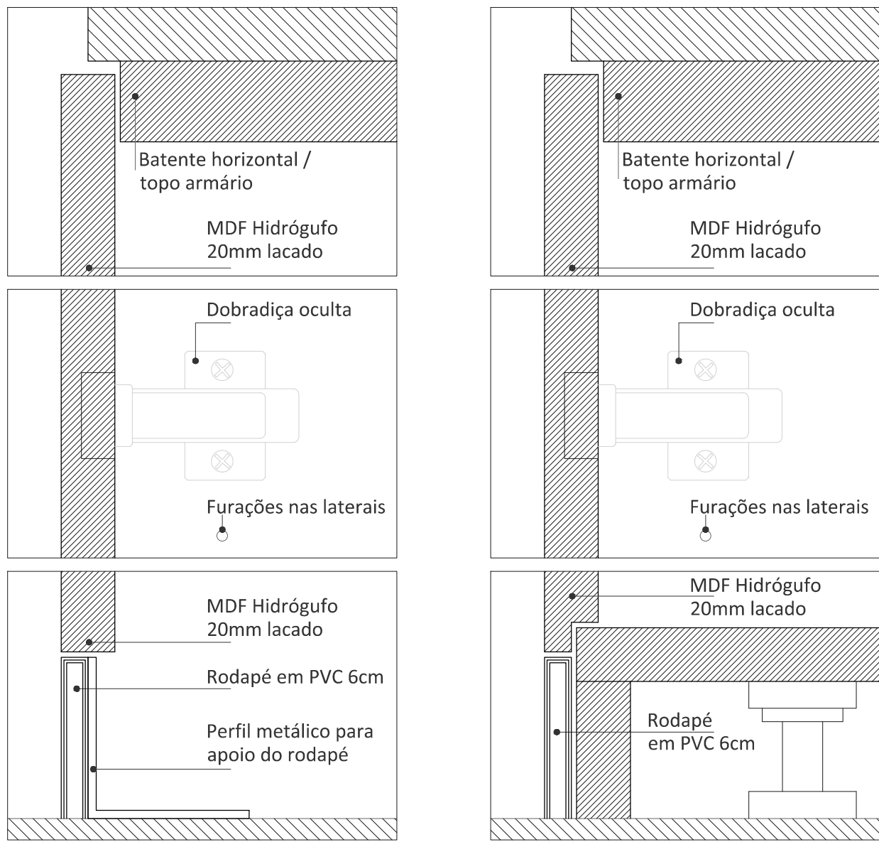
CORTE TRANSVERSAL ZONAS DE PASSAGEM
