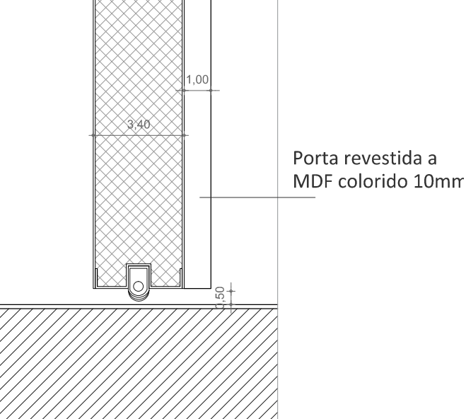
P6 - CORTE VERTICAL PELO ENCAIXE DE REVESTIMENTO EM MDF COLORIDO NA PORTA DUPLA DO AUDITÓRIO esc 1.2
