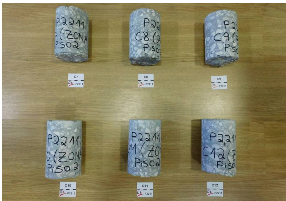
Fig. 53 – Avaliação da resistência atual dos betões. Carotes extraídas de lajes – C7 a C12 (lajes do pavimento do piso 2), destinadas ao ensaio de rotura à compressão, antes da preparação dos provetes. Betões de aspeto compacto, com agregados grosseiros, predominantemente, de natureza calcária que, em geral, apresentam distribuição homogénea. Com formas angulares, os agregados grosseiros, possuem dimensões até 22mm.
