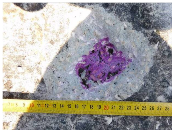
Fig. 49 – Idem. Idem. Pormenor da sondagem realizada para medição da profundidade de carbonatação.
