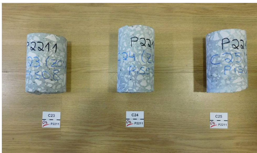
Fig. 55 – Avaliação da resistência atual dos betões. Carotes extraídas de lajes – C23 a C25 (lajes do pavimento do piso 8), destinadas ao ensaio de rotura à compressão, antes da preparação dos provetes. Betões de aspeto compacto, com agregados grosseiros, predominantemente, de natureza calcária que, em geral, apresentam distribuição homogénea. Com formas angulares, os agregados grosseiros, possuem dimensões até 19mm.
