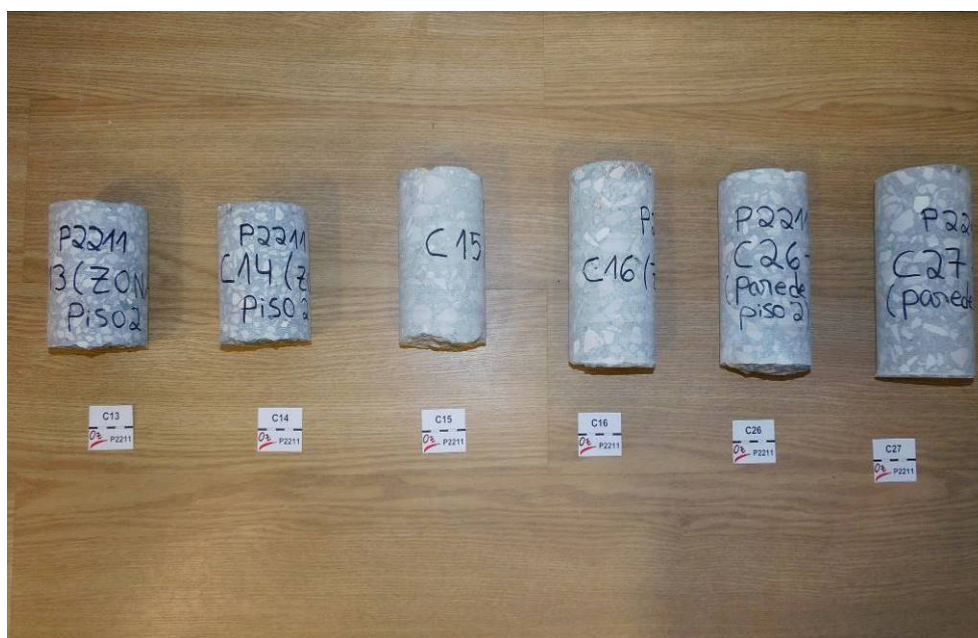
Fig. 50 – Avaliação da resistência atual dos betões. Carotes extraídas de paredes – C13, C14, C26 e C27 (paredes do piso 2), C15 e C16 (paredes do piso 0), destinadas ao ensaio de rotura à compressão, antes da preparação dos provetes. Betões de aspeto compacto, com agregados grosseiros, predominantemente, de natureza calcária que, em geral, apresentam distribuição homogénea. Com formas angulares, os agregados grosseiros, possuem dimensões até 22mm.
