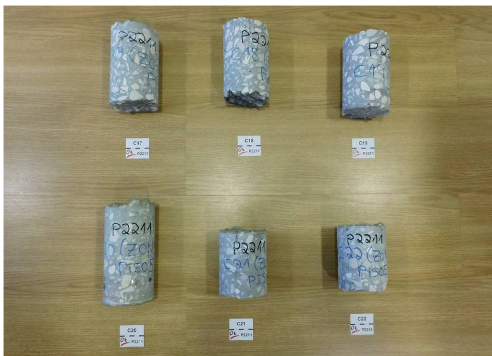
Fig. 54 – Avaliação da resistência atual dos betões. Carotes extraídas de lajes – C17 a C22 (lajes do pavimento do piso 5), destinadas ao ensaio de rotura à compressão, antes da preparação dos provetes. Betões de aspeto compacto, com agregados grosseiros, predominantemente, de natureza calcária que, em geral, apresentam distribuição homogénea. Com formas angulares, os agregados grosseiros, possuem dimensões até 22mm.
