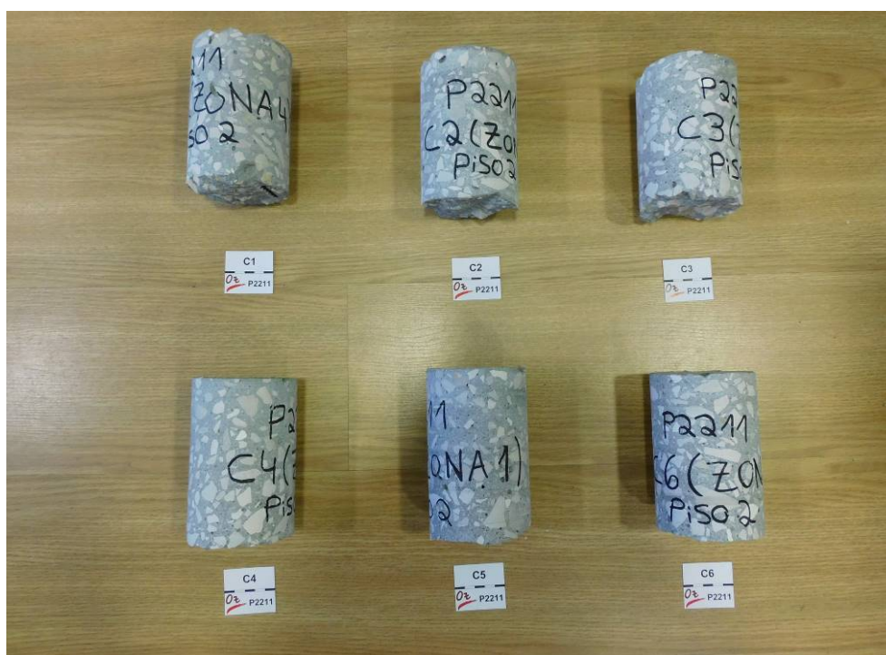
Fig. 52 – Avaliação da resistência atual dos betões. Carotes extraídas de lajes – C1 a C6 (lajes do pavimento do piso 2), destinadas ao ensaio de rotura à compressão, antes da preparação dos provetes. Betões de aspeto compacto, com agregados grosseiros, predominantemente, de natureza calcária que, em geral, apresentam distribuição homogénea. Com formas angulares, os agregados grosseiros, possuem dimensões até 21mm.
