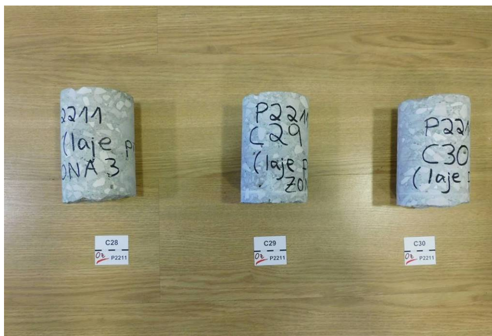
Fig. 51 – Avaliação da resistência atual dos betões. Carotes extraídas de lajes – C28 a C30 (lajes do pavimento do piso 0), destinadas ao ensaio de rotura à compressão, antes da preparação dos provetes. Betões de aspeto compacto, com agregados grosseiros, predominantemente, de natureza calcária que, em geral, apresentam distribuição homogénea. Com formas angulares, os agregados grosseiros, possuem dimensões até 21mm.
