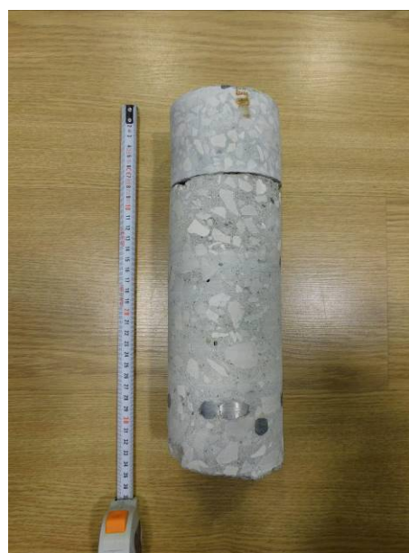
Fig. 19 – Idem. Idem. Idem. Pormenor da carote adicional extraída para aferição da espessura da laje. Laje constituída por duas camadas independentes, a primeira camada de betão armado, com 0,22m de espessura, sobre a qual assenta a segunda camada, de betão (com aparente ausência de armaduras), com 0,065m.
