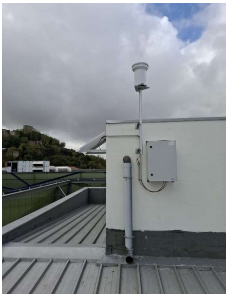
Sistema de medição de pluviosidade instalado no edifício do Mercado Municipal e Grupos Novos e Tubagem no R. Pousos
