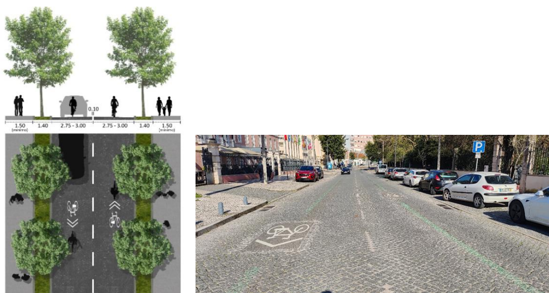
Figura 31. Perfil-tipo de canal partilhado com o automóvel e imagem de referência
