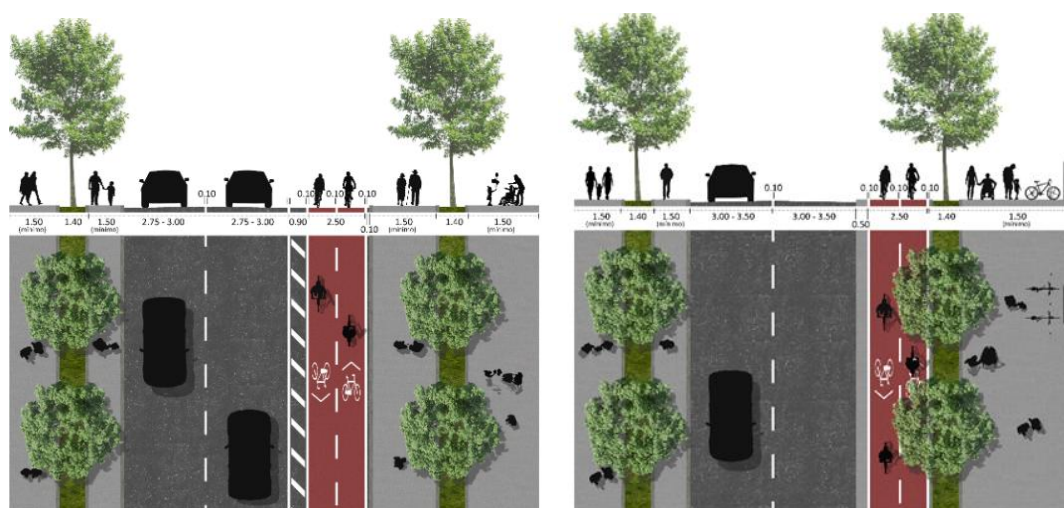
Figura 29. Perfis-tipo de canais próprios – pista e corredor
