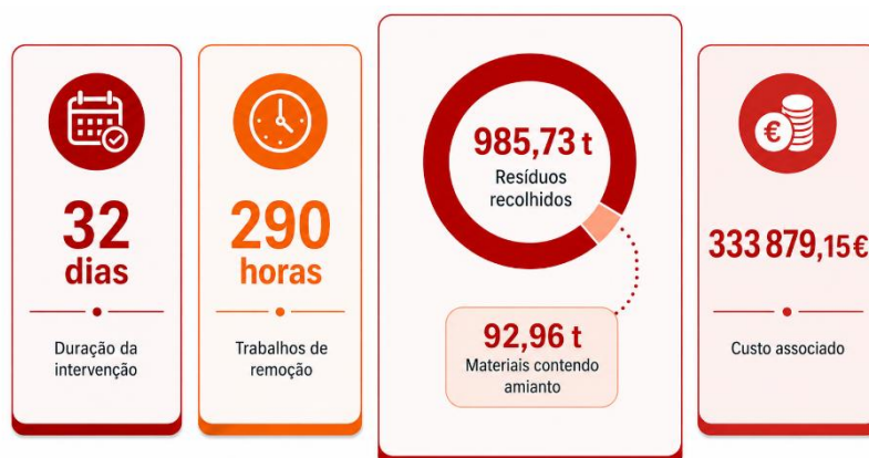
Figura 29 - Principais indicadores da operação de gestão dos resíduos depositados no estaleiro da Boa Vista
