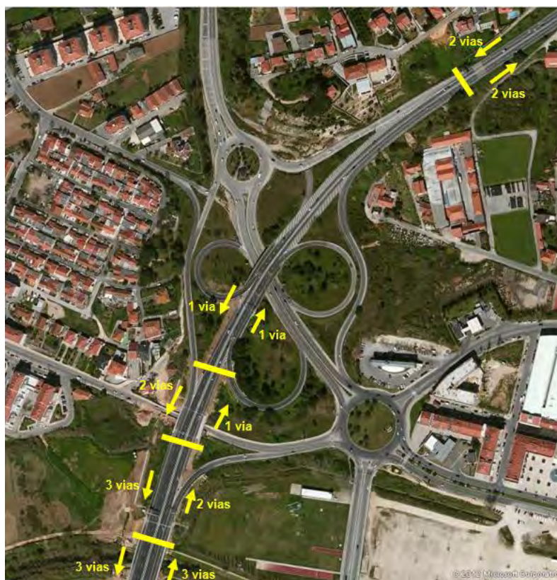
Figura 13. Evolução dos perfis transversais do IC2 no Nó da Almuinha Grande
